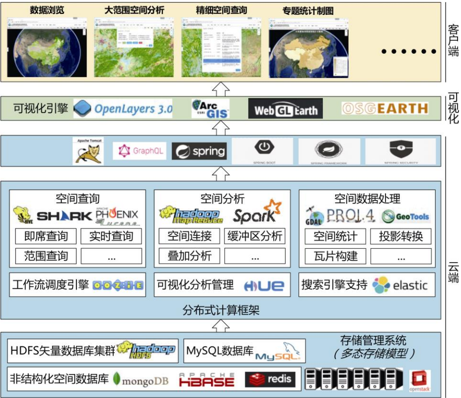
图 1 基于多云共生的海洋时空分布式存算一体化架构
