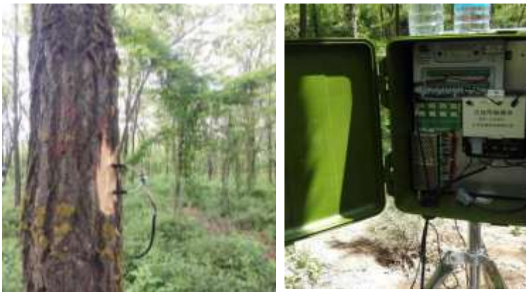
图2 树干液流仪器设置与安装
